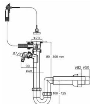
**Raumspär- Röhrensiphon für Wasch-/Spülbecken mit Reduktion für 5/4" Abgang 40 mm**
